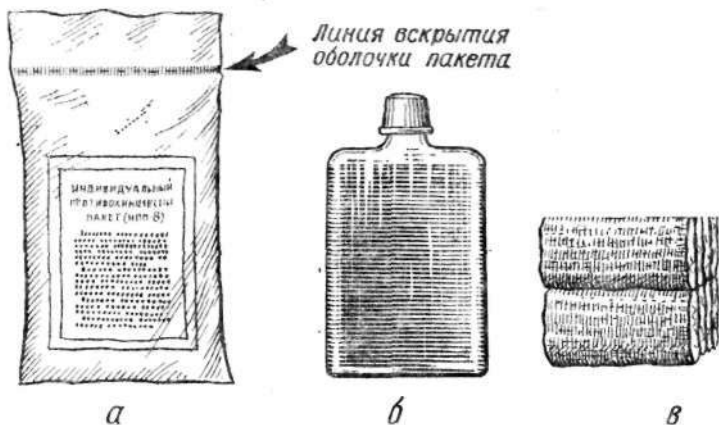
Рис. 25. Индивидуальный противохимический пакет ИПП-8: а — общий вид; б — флакон с жидкостью; в — ватно-марлевые тампоны
